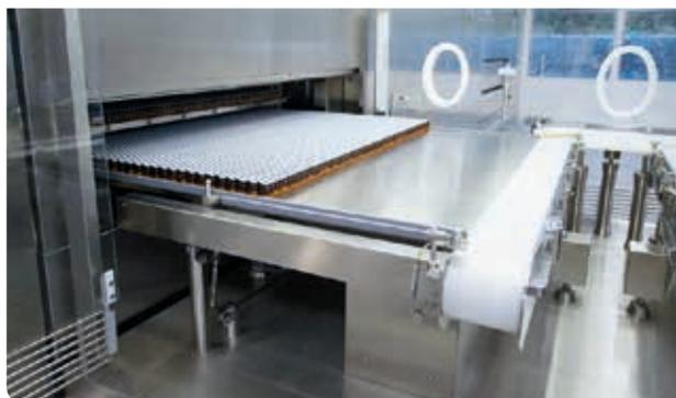
Déchargement et séparation sur un chariot de déchargement avec machine à border attachée
