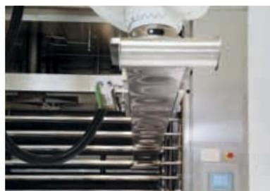
Aspiration automatique d'un produit en vrac avec système robotique
