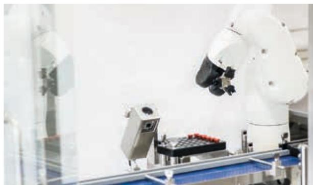
Placement automatique des capteurs de température du produit
